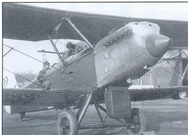
Разведчик-штурмовик Поликарпова Р-5. Под мотором перед стойками колес шасси виден выдвижной радиатор
