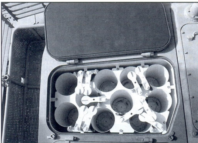
Вид сверху на ящик боеукладки
